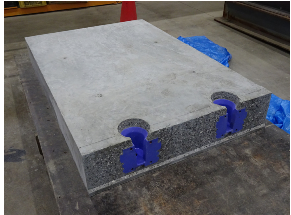
プレキャスト床版の製作完了
