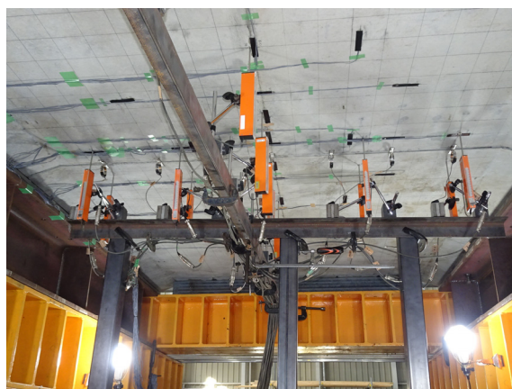
(d) 下面の計測器の設置状況
