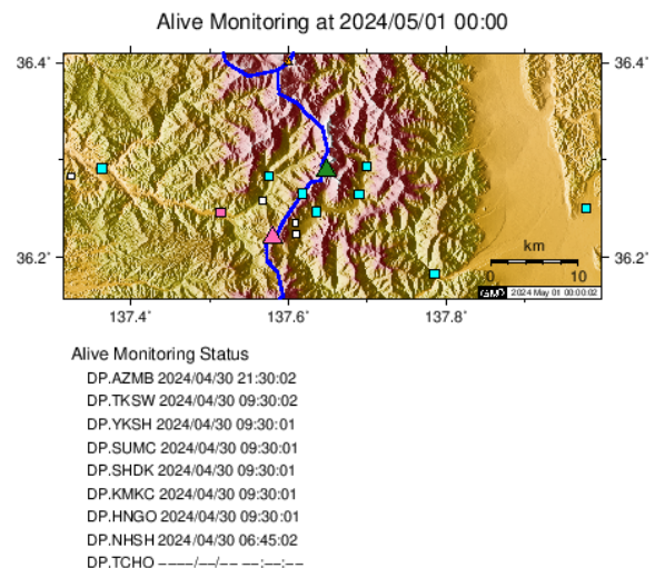
Fig.3a：観測状況確認用データの例。毎日定時の各機器の応答の確認状況。これにより、機器のハングアップ等の障害を検出する。各観測点の最終チェック時刻が表示されている。
