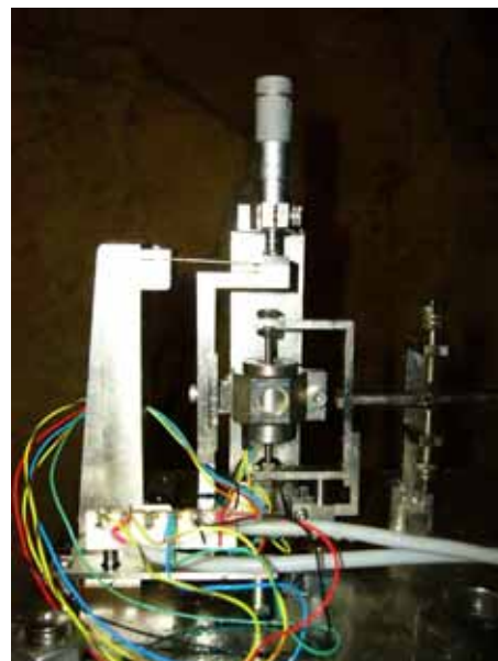
写真2：水管傾斜計センサー部
