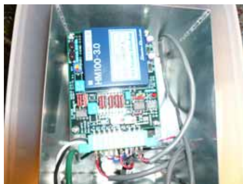
写真 7：アンプ収納用鉄箱
