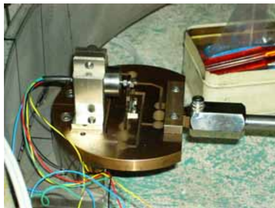
写真9：メカニカル拡大システム
