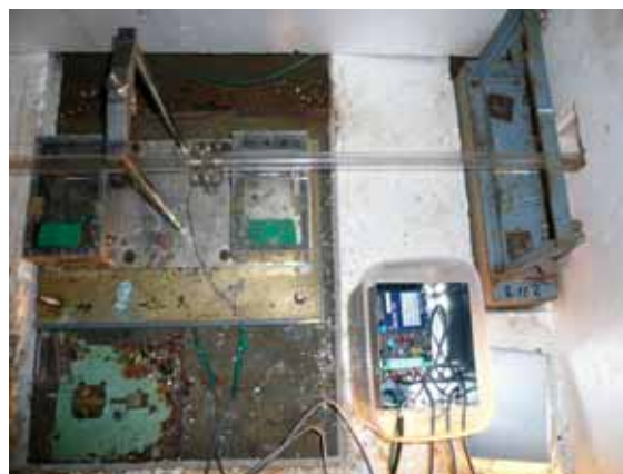
写真 5：改良後の差動トランスとアンプ
