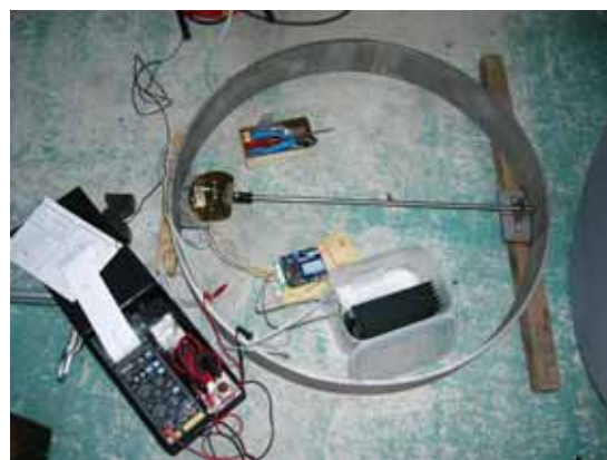
写真 8：尾上式簡易歪計（試作）
