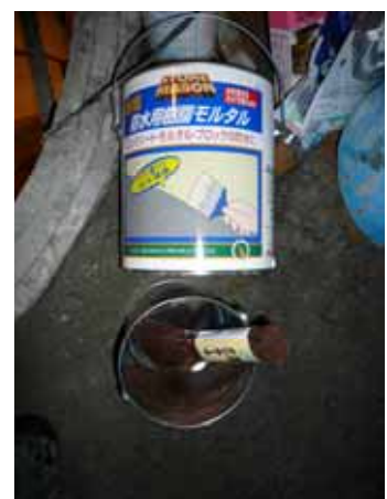
写真 18：防水用樹脂モルタルと棕櫚刷毛
