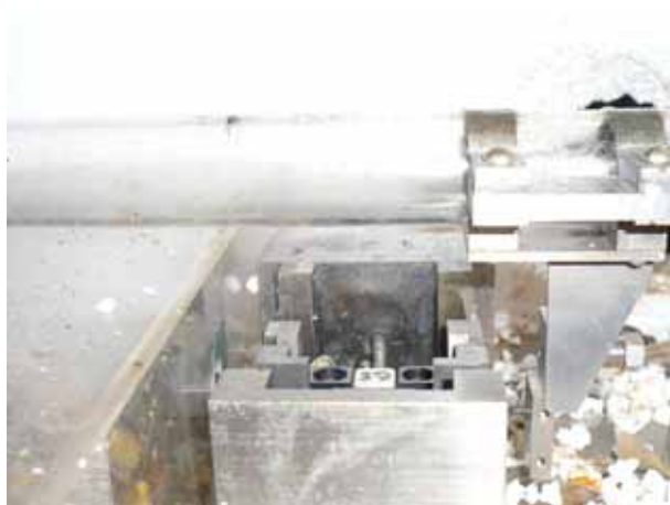
写真 6：マグネセンサー計測装置と板バネ矢印の接続部分を切り離す
