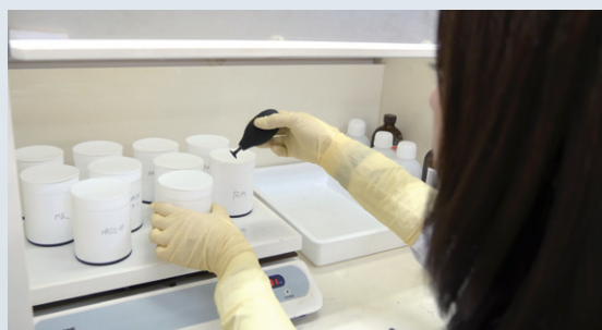
図2 片麻岩から取り出した石英を薬品で溶かすために加熱する
