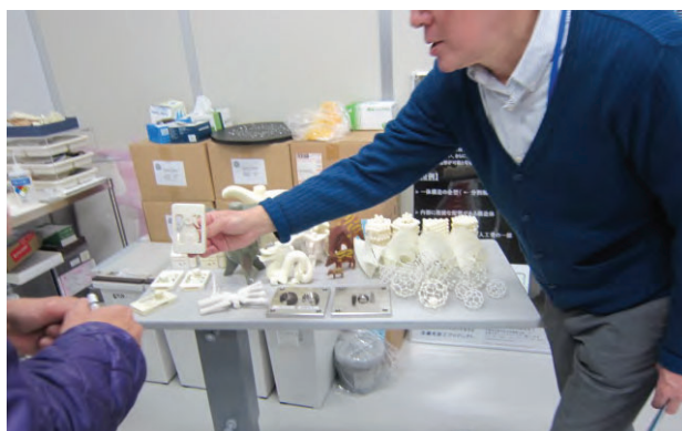
図 11 3次元光造形装置で作成した造形物
