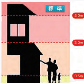
浸水想定区域図の 浸水ランクによる色分け (国交省洪水浸水想定区域図作成 マニュアル(第4版))
