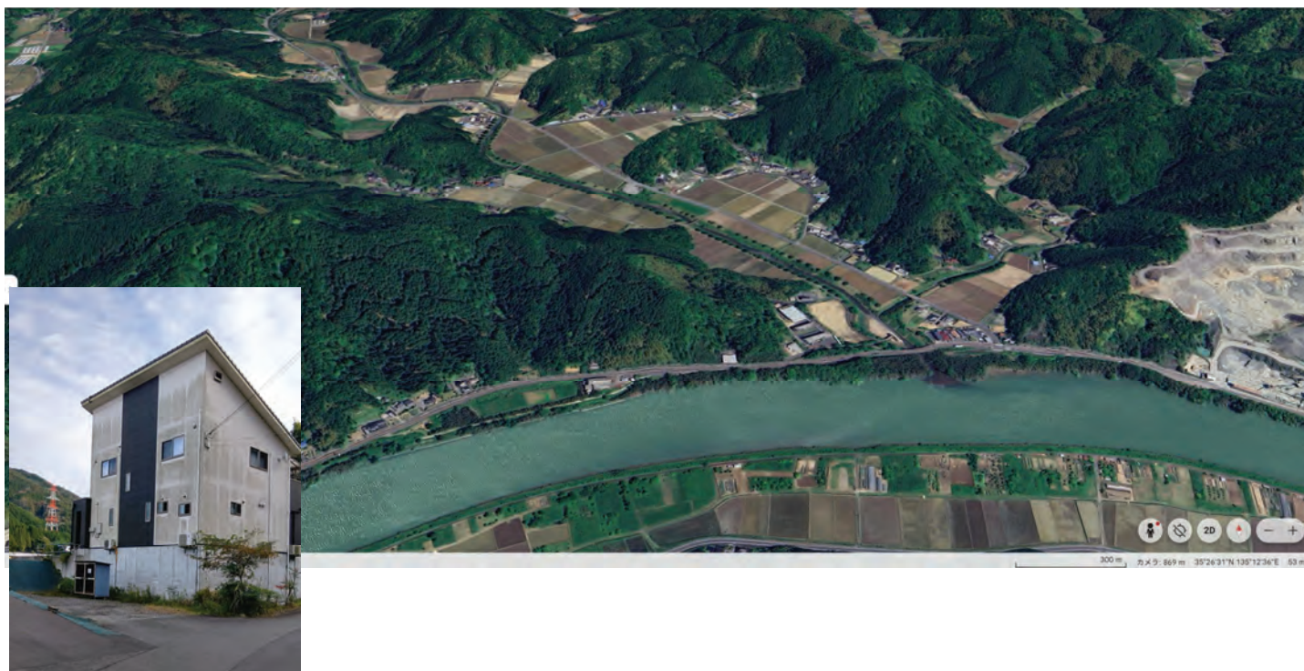
由良川－由良川下流緊急防災対策事業（2004年～）：災害危険区域指定 → 輪中堤／宅地嵩上げ補助
