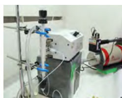
A2 フード B10 Lu-177分離精製装置
