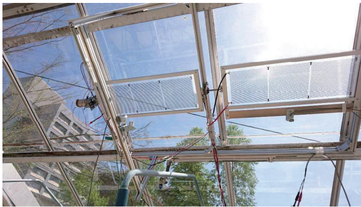
写真 4：実験用ハウスに装着した太陽光パネル (2017 年 7 月 27 日に李治が撮影)
