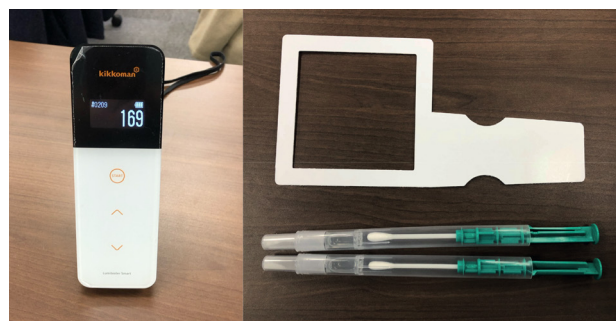
写真2. ATP測定（A3法）による清浄度評価検査（左：リミテスターSmart、右：リシバックA3 Surface / SWABふき取り棒）
