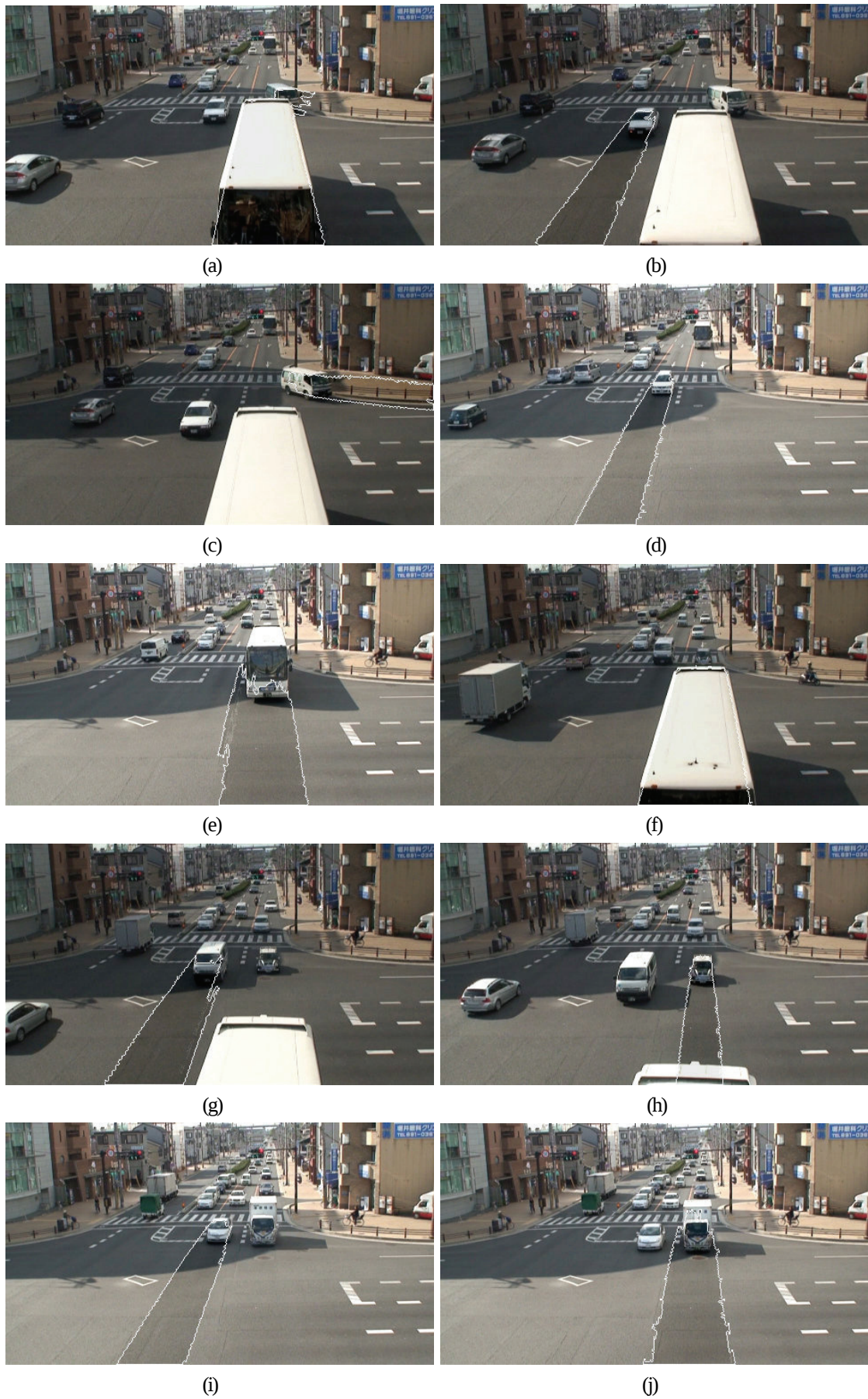
図-9 短時間に日照変化が生じた時の車両軌跡の抽出結果. (a)から(j)は時間順に抽出した車両を表し, その間の約16.7秒間に通行した車両は全て抽出しているが, (f)では誤って(e)で抽出したバスを再度抽出している.
