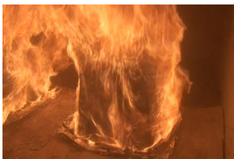
図 5.19 2 個の試験体が室中央で燃焼している様子（実験 Comp 5, 180 秒時点）
