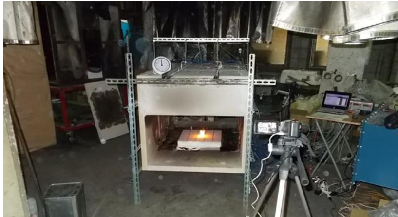
図 3.6 模型室燃焼実験の写真（実験 b6）
