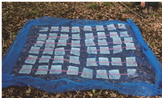
図2：京都府北部大江山の林床に設置されたリターバッグ。野生動物に持ち去られないように市販の園芸用ネットを被せて保護している(2016年6月著者撮影)。
