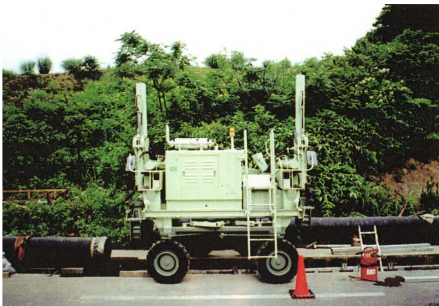
図 5.12 パイプ敷設クレーン (車道側側面)
