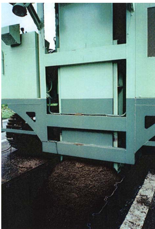
図 6.26 締固め機ホッパー （埋め戻し土投下排出中）
