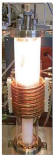
写真1: 放射化金属の加熱模擬実験の様子
