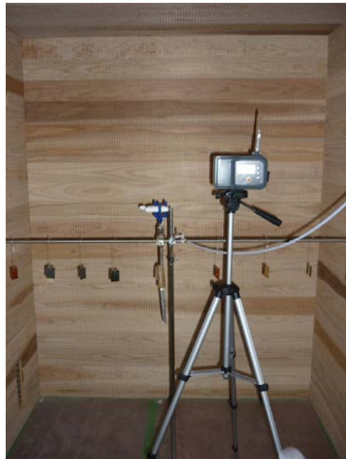
図B 保管庫内に捕集管設置
