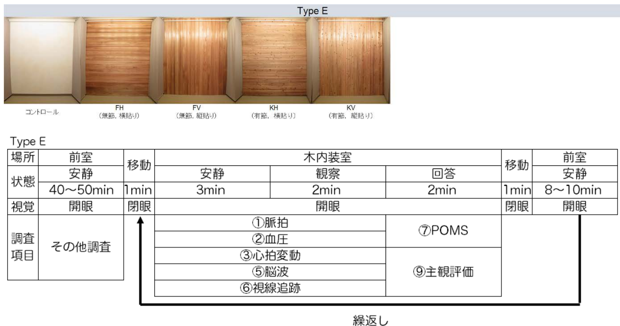
図 13 呈示刺激として新たに供試した実大木質壁面（Type E）と実験プロトコル 2400 mm (W) × 2400 mm (H)
