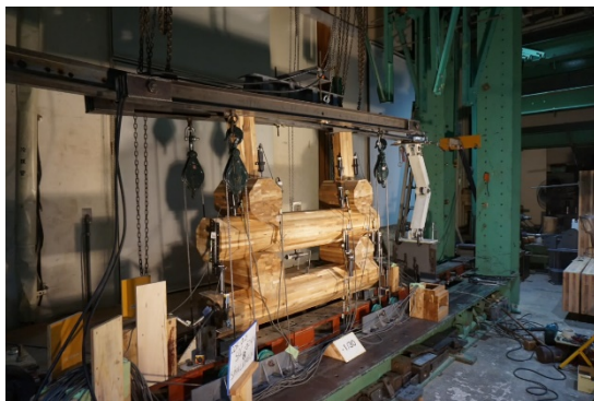
図 8：（左）Simalungun 族柱脚架構を模した試験体、（右）水平荷重-変形角関係
