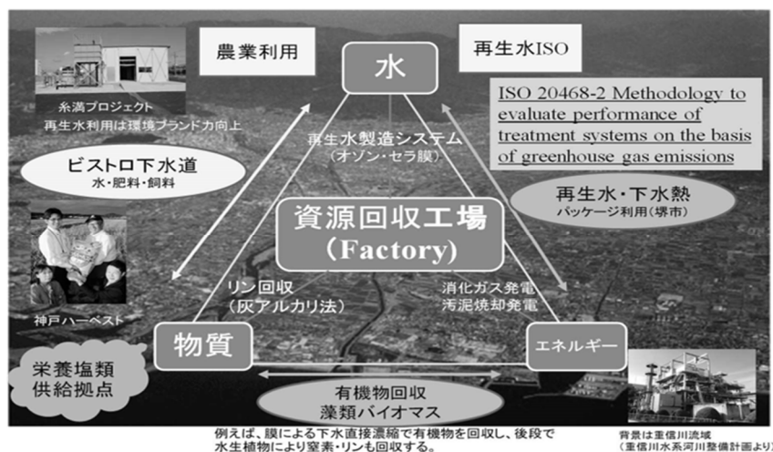
図 2-8 資源回収工場コンセプト
