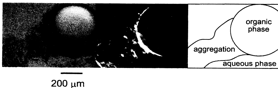
図4 会合体の生成様相の偏光顕微鏡像：左図は透過光顕微鏡像，中図はクロスニコルでの偏光顕微鏡像．右図は油相・水相・会合体を模式的に示したものである．スケールバーは 200 \mu\text{m} ．
