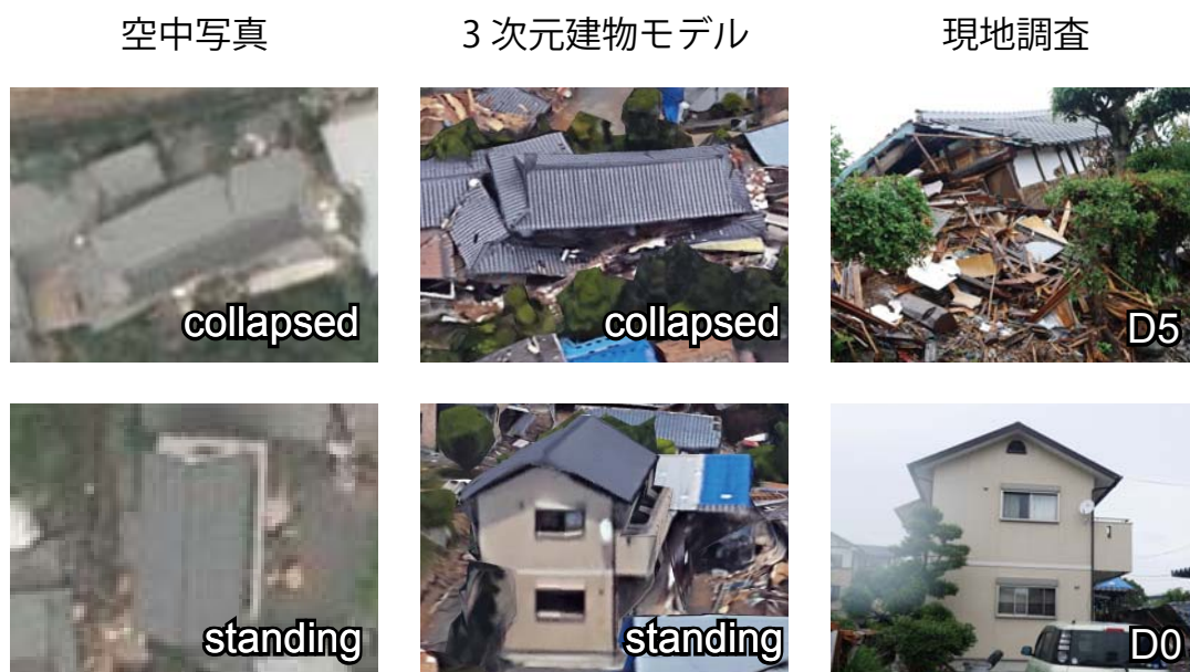
図 4 空中写真分析と現地調査による判定結果の比較の例.
